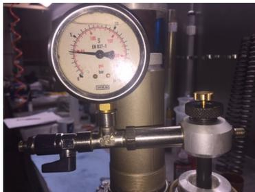
2) INSERIRE 5 BAR ALL'INTERNO DEL PRESSURIZZATORE.
